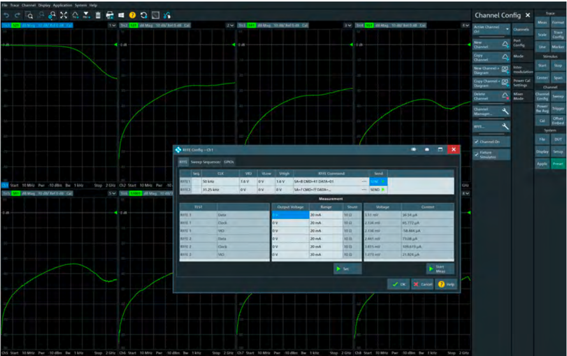
外部R&S®ZN-Z15 RFFE GPIOインタフェースとRFFE設定メニューを使用した、アンテナ切り替えモジュールの簡単な設定
