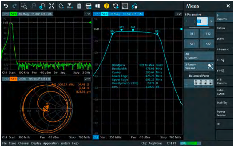
バンドパスフィルターの特性評価。 主要なパラメータの値が表示されます。
