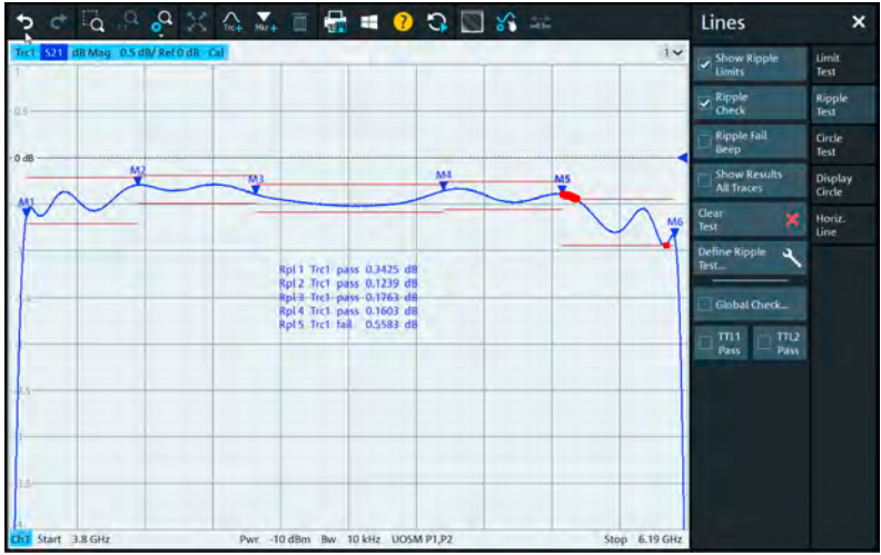
リミットラインと合否判定表示による バンドパスフィルターの通過帯域のリップルテスト。
