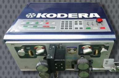
自動電線切断皮剥装置
