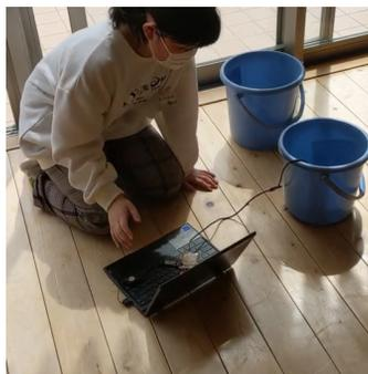
水温が15℃以上になるとLEDが光るプログラミングを行い、暖かい水と冷たい水にセンサーを入れて動きを確認します。
