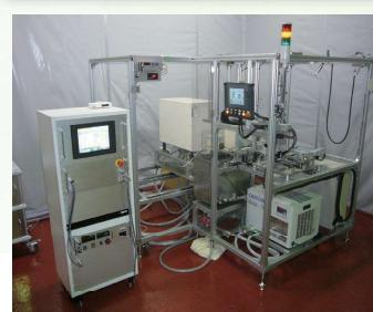
試作開発装置：プロトタイプ型アルミ熱処理装置
