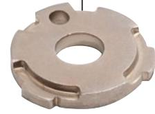
2009年AIDA製UL250tonプレス機を購入しました。この機械は高剛性と精度UPを図ったもので、この機械の特徴を生かす部品として上下からの潰し加工で、その潰し精度を要求される部品として日々生産しています。またASSYする部品も同時に受注しており、ASSY精度の確認も社内で行える形態を整えています。
