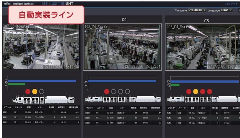
図4:COLMINA 生産効率支援モニタによる生産ラインの可視化イメージ
